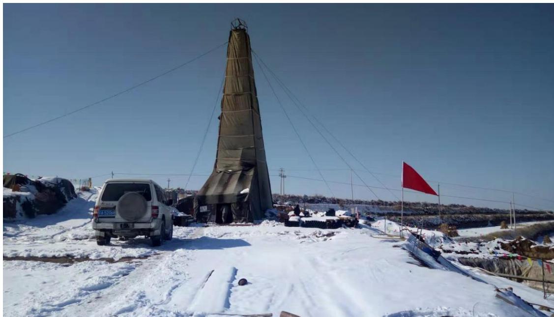
图 6-6 XY-6B 绳索取芯钻机现场施工
